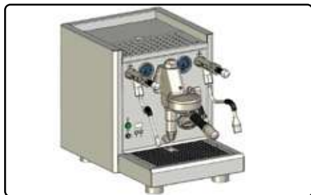
Ilus. 9 Portafiltro instalado, mango orientado hacia delante
