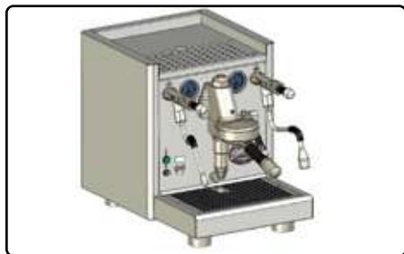
Fig. 9 Porte-filtre installé, poignée tournée vers l'avant
